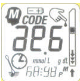
Onjuiste weergave na schermtest. Conclusie: het schermje is kapot en de meter is onbetrouwbaar.
