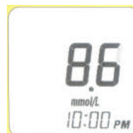
Een kapot meterscherm geeft een onjuiste weergave van het meetresultaat (hier bijvoorbeeld 8.6 in plaats van 8.8).
